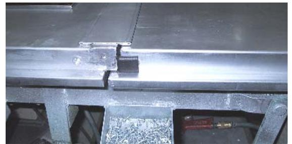
Alinear las alturas de bisagra. Acoplar los pernios para permitir el movimiento de giro de la barra de altura. Ver figura nº2
