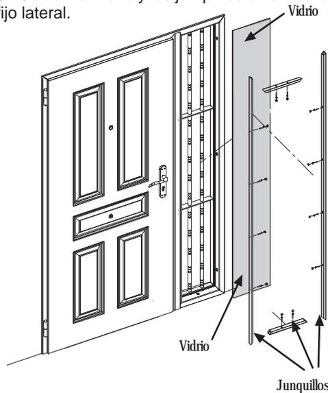
**6º.** Terminar de atornillar los junquillos con los tornillos DIN 7981 4.2x19 y seguidamente ocultarlos colocando los tapones de diámetro 10 mm, como indican en la figura
