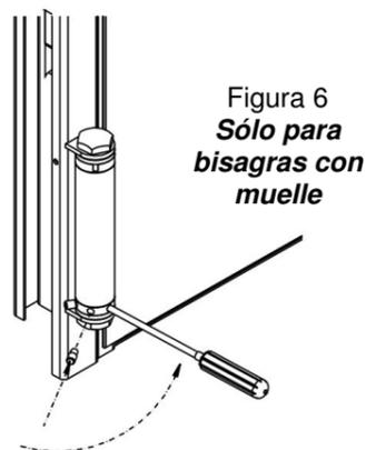
4. En caso de que la puerta monte bisagras con muelle recuperador, se deberá proceder al tensado del mismo, para lo cual se empleará un destornillador con el que giraremos el eje y colocaremos el tope tensor en la posición que consideremos óptima (ver figura 6).
