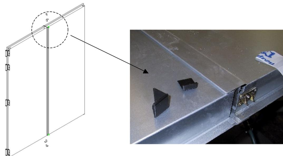
2.- Montar el marco ensamblando las barras y la riostra siguiendo el siguiente esquema, y atornillarlo empleando los tornillos rosca chapa DIN 7504N autotaladrantes 4,2x13 suministrados. Ver figuras 3 y 4.
