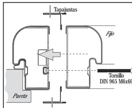
5º. Colocar los tapajuntas y atornillar el fijo a la puerta con los 3 tornillos DIN 965 M6x60 por los agujeros del Fijo, quedando así atrapados los tapajuntas.
