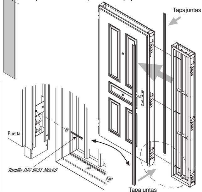
Si la puerta también lleva un fijo superior, se recomienda no apretar los 3 tornillos DIN 965 M6x60 para facilitar el montaje posterior del fijo superior.
