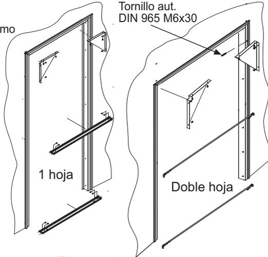
**Esquema de colocación (Fig. 1)**
