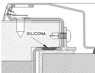
4. **Si la puerta posee mirilla, hay que desmontarla y poner silicona para el sellado entre el vidrio y la lana de roca (según la figura siguiente), volver a montar la mirilla.**
